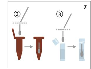
1) Röhrchen öffnen und Teststäbchen im Agar-Gelee versenken, abbrechen und Röhrchen fest verschließen.
