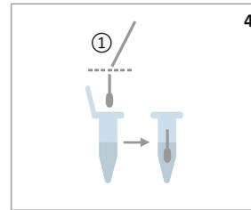
Röhrchen öffnen und Teststäbchen im Agar-Gelee versenken, abbrechen und Röhrchen fest verschließen.
