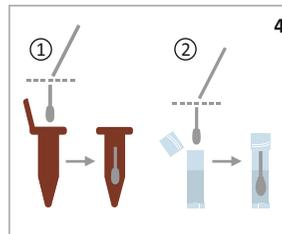
1) Röhrchen öffnen und Teststäbchen im Agar-Gelee versenken, abbrechen und Röhrchen fest verschließen.
